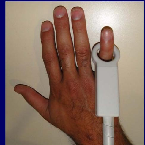
**Figura 2. Bobina de microscopía de 23 mm.**
