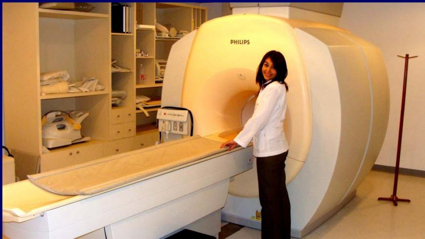
**Figura 1. RM de alto campo.** Permite la adquisición de imágenes con FOV pequeños, buena relación señal/ruido y alta resolución espacial utilizando bobinas de microscopía.
